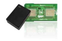
MyBeacon Pro シリーズは、商用利用向け Beacon の必須機能である位置測位の精度向上と端末の負荷を軽減する通信方式と、不正アクセス防止や成りすまし防止などの電子認証、位置情報や URL のデータストレージ、およびセンサーとの連動、センサーデータの取得などができる通信方式を、それぞれ専用の通信モジュールを使って同時に実現しています。本製品群では、通信モジュールを 2 つ内蔵していても、電子認証および位置情報や URL のデータストレージ機能を利用しない場合は、片方の通信モジュールの動作を止めることにより、全体の消費電力を通信モジュールが 1 つの Beacon と同じレベルに抑えることができます。
