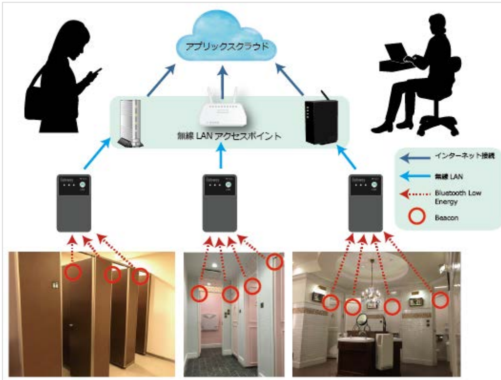
上図:各地のトイレの扉の開閉状況を検知して、Beacon→BeaBridge→アプリクスクラウドに送信する例
